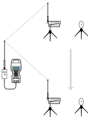
In nur wenigen Minuten ist das System aufgebaut, und es können Start-/Ziel-/Zwischenzeitimpulse gemessen werden, ohne dabei durch Kabel eingeschränkt zu werden. Die Funkreichweite beträgt 300 m.
