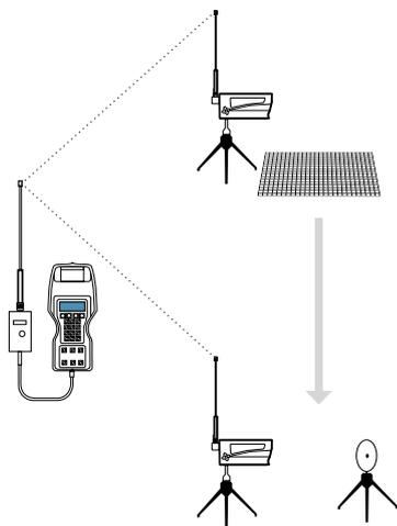
Mit dem Kit **RACETIME2 LIGHT RADIO** können außerdem Reaktionszeiten berechnet werden, wenn die Polifemo Light Radio Fotozelle an die Startmatte angeschlossen wird. In diesem Fall fungiert die Fotozelle als Start-Beeper, d. h., dass der Zeitmesser die Zeit ab dem ausgegebenen Akustiksignal der Fotozelle bis zur tatsächlichen Lösung von der Matte berechnet.
